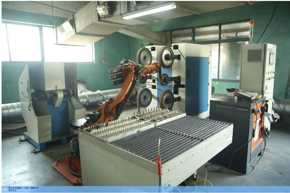
以小角阀为例，夹具须与小角阀口径匹配，且机器人配合夹具在上件台上取件时，要尽量避免触碰，所以夹具的设计应尽量简单。 打磨机的使用需要用到若干动力轮，就打磨小角阀而言，需要四个动力轮，分别为主动轮、张紧轮、惰轮和接触轮。因为打磨作业基本上是在接触轮上完成，所以接触轮的选材很重要，既要考虑消耗问题，又要考虑硬度要求。通常，接触轮的消耗量很小，应该考虑砂带的消耗量。 抛光机的使用需要与工业蜡配合，且所选取的抛光轮需要满足抛光机的动平衡。当机器人夹取工件进行抛光作业时，需要满足工件的抛光要求，不能出现大的干涉。就小角阀而言，一般抛光进行一次，就要使用一次蜡。诺万机器人抛光打磨工厂自动记录操作者经验过程，自动产生路径。
