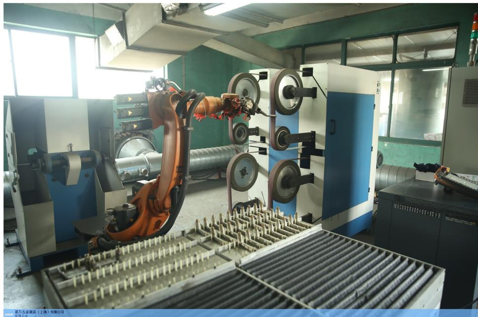
机器人在打磨抛光领域有哪些应用？打磨抛光机器人用于替代传统人工进行工件的打磨抛光工作，主要用于工件的表面打磨、棱角去毛刺、焊缝打磨、内腔内孔去毛刺、孔口螺纹口加工等工作，可应用于卫浴五金行业、IT行业、汽车零部件、工业零件、医疗器械、木材建材家具制造、民用产品等行业。实际上打磨抛光机器人的应用行业是非常\*\*\*的，应用打磨抛光机器人能够缩短产品改型换代的周期，减少相应的投资设备，打磨抛光机器人还具有可再开发性，用户可根据不同样件对机器人进行二次编程。
