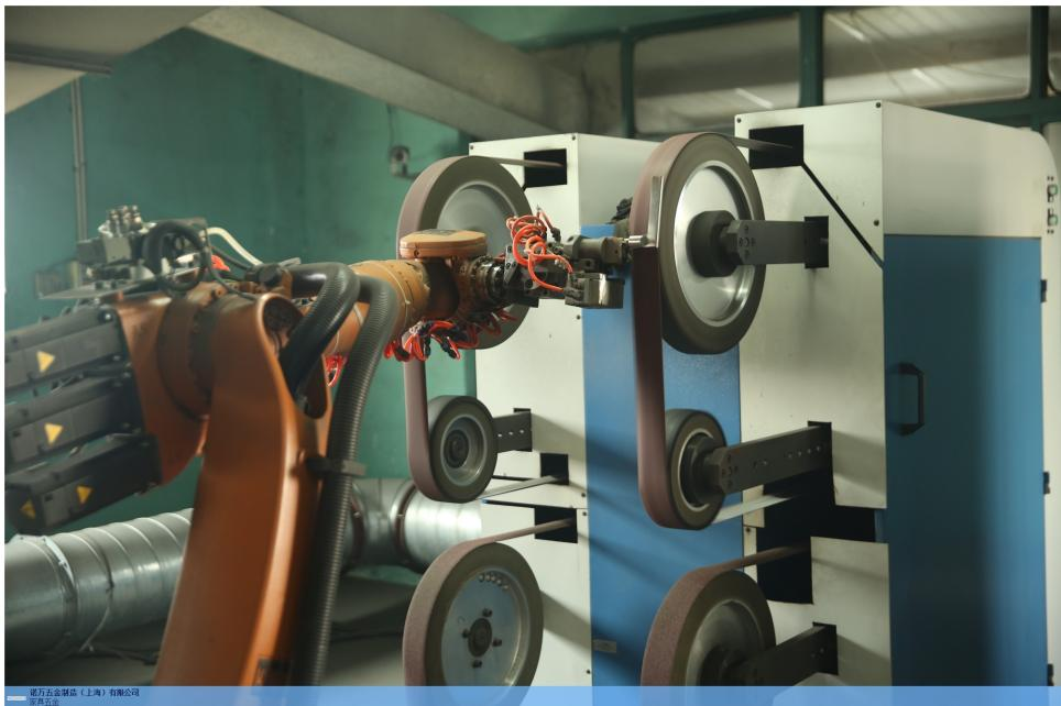
抛光机的使用需要与工业蜡配合，且所选取的抛光轮需要满足抛光机的动平衡。当机器人夹取工件进行抛光作业时，需要满足工件的抛光要求，不能出现大的干涉。就小角阀而言，一般抛光进行一次，就要使用一次蜡。
